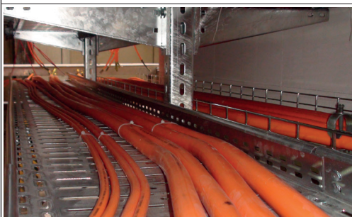
Stan systemu przed badaniem ogniowym
