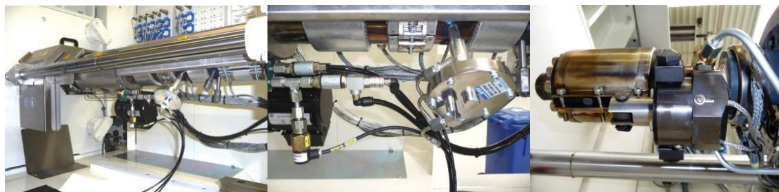
Rys. Jednostka wtryskowa CELLMOULD ; dysza do wtrysku gazu i dysza zamykana igłowo
