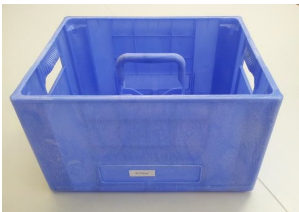
Rys. Przykład skrzynki wykonanej w technologii CELMOULD redukcja wagi wypraski z 1480g do 1340 g (- 9.45%) czas docisku z 6 sec do 1 sec. czas wtrysku z 7 sec do 1,5 sec siła zamykania z 650t do 500t
