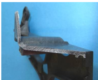
PA+GF s=1,8 mm redukcja ciężaru – 5%
