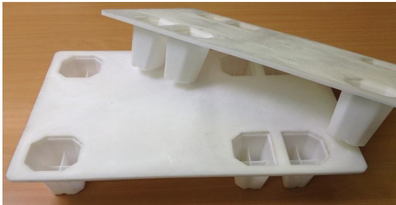
Rys. Paleta z PP. Ciężar detalu kompaktowego 2.650g. Ciężar wypraski wykonanej w technologii CELLMOULD® 1.920 g. Redukcja wymaganej siły zamykania z 400 na 200t
