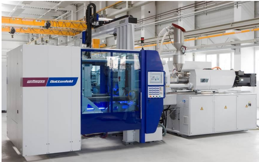
Zdjęcie. 3: Duża wtryskarka hybrydowa MacroPower 450/2100 E z w pełni elektryczną jednostką wtryskową.
