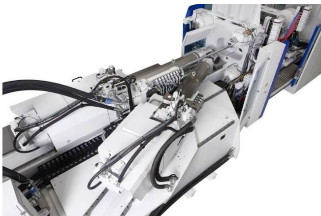
Zdjęcie. 4: Jednostka wtryskowa MacroPower 450/5100H/2250Y dla produkcji doniczek Lechuza® w technologii sandwich
