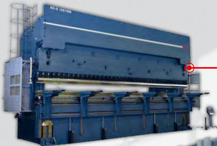
Prasa krawędziowa DURMA pracująca w układzie TRIO. Długość gięcia 12 m, nacisk 1200 ton.
