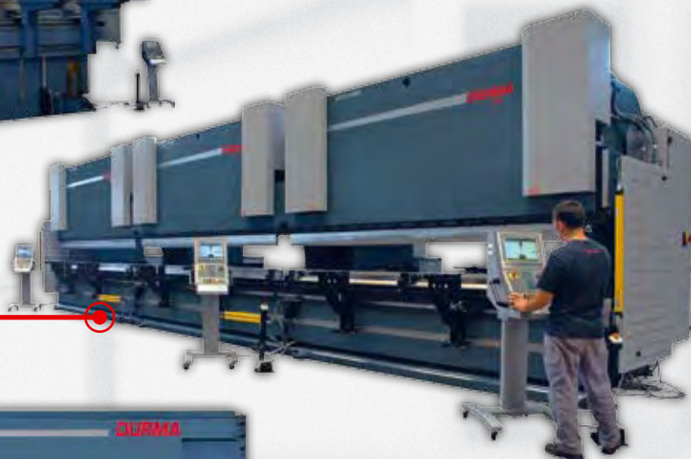
Nożyce gilotynowe DURMA. Długość cięcia 10 m, max. grubość 13 mm. Zainstalowana w Polsce.
