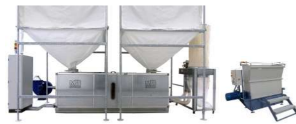
11. SILOS DO PRZECHOWYWANIA REGENEROWANE- GO I CZYSTEGO POLISTYRENU - ROZDRABNIACZ DO RESZTEK Z POLISTYRENU
