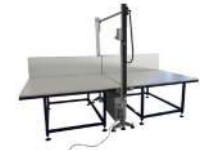
20. MASZYNA DO CIECIA BLOKÓW STYROPIANOWYCH
