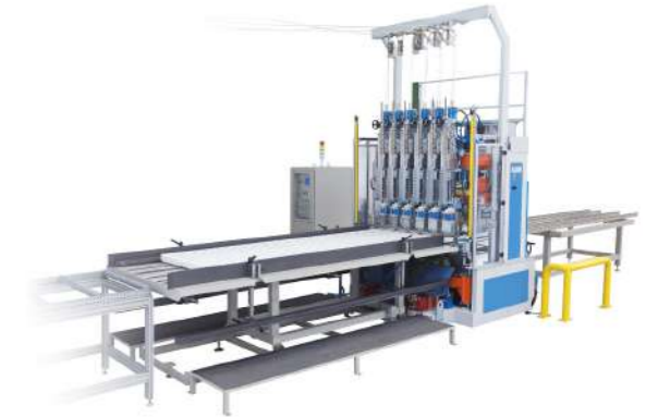
17. ZAUTOMATYZOWANA SPAWALNIA I MONTOWNIA PŁYT PRZESTRZENNICH
