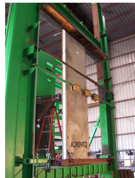
Test zginania kompresji na panelu ściennym
