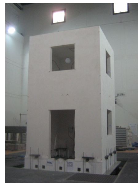
Badanie sejsmiczne na stole - wytrzymałość
