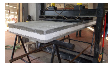
Test zginania na panelu podłogowym
