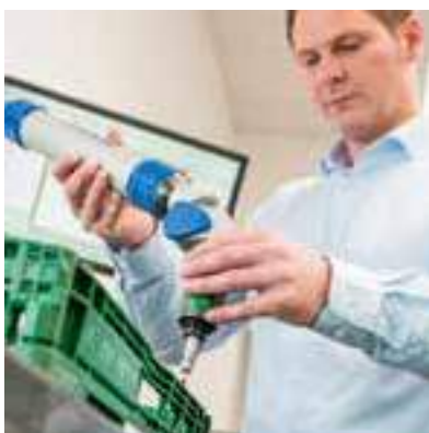
pomiar za pomocą ramienia Faro
