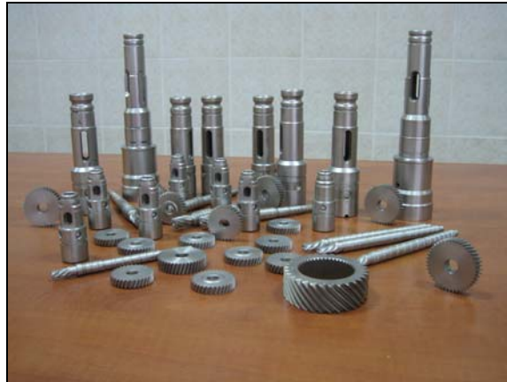
Rys. 5 Czystość detali po nawęglaniu próżniowym realizowanym w Bodycote Polska
